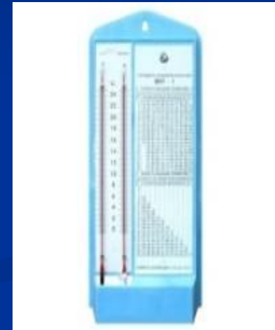
psihrometrul staționar (August)
