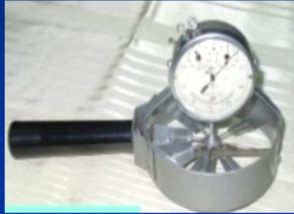
anemometru cu palete
