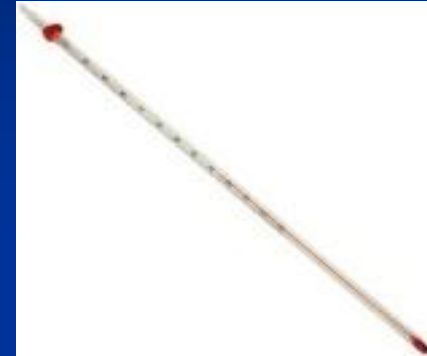
termometrul minimal (cu alcool)
