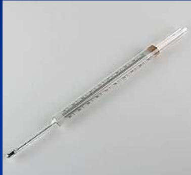
termometrul maximal (cu mercur)
